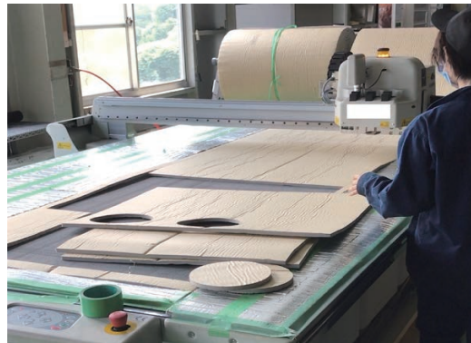
ダクト図面を使用して レシプロ式自動カット機でのカットも可能
